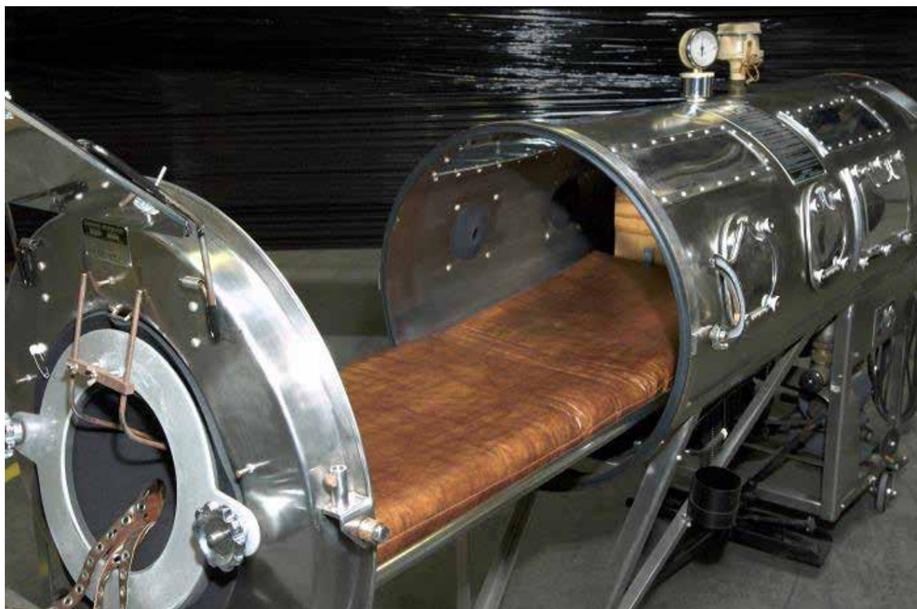
نمونه‌ای از ونتیلاتورهای فشار منفی ابتدایی؛ این دستگاه در سال ۱۹۵۰ ساخته شده است.
